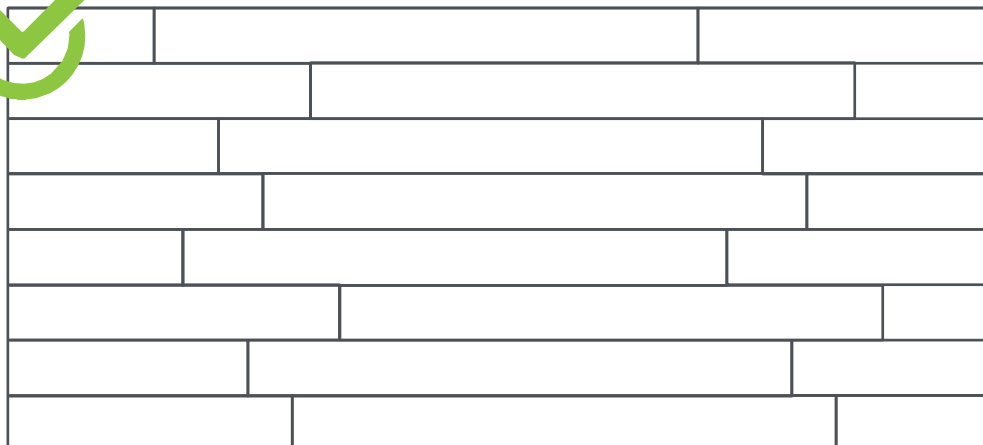
Pose décalée (entre 2 et 20CM)
